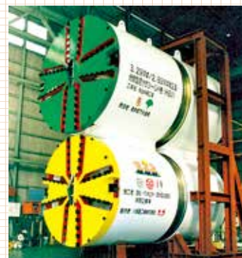
東京都発注の下水道工事で使われたH&Vシールドマシン。
