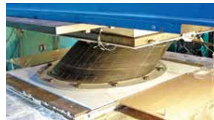
免震ゴムの大変形試験 1,000トンを超える鉛直荷重を支えながら、水平方向に変形能力を保有する。 提供:竹中工務店
