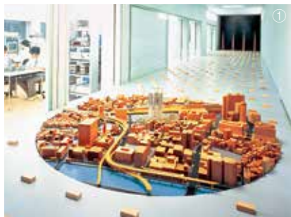
①実際の都市の模型をつくり、そこに大型扇風機で風を送り、ビル風を調べる風洞実験室
