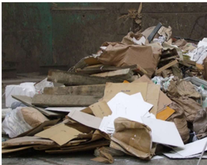
写真1-1. 新築・増改築（非木造）工事で発生した建設混合廃棄物サンプル
