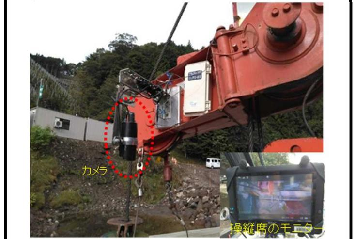
クレーン操縦席からの死角を、操縦席モニターで確認可能
