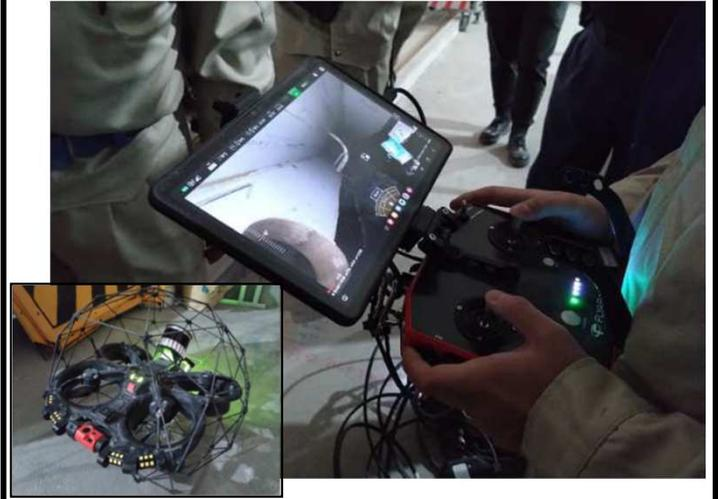
閉塞空間の多い構造物内点検をドローンを用いて実施
