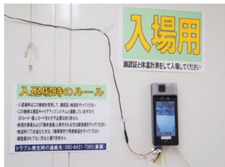
① 現場の入退場を顔認証検温システムでチェック。CCUSともひも付けされ、人の管理を一括で運用している
