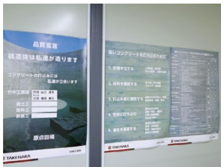
① 品質管理のポイントを現場内に掲示。ここではコンクリートの打ち込みについて説明している
