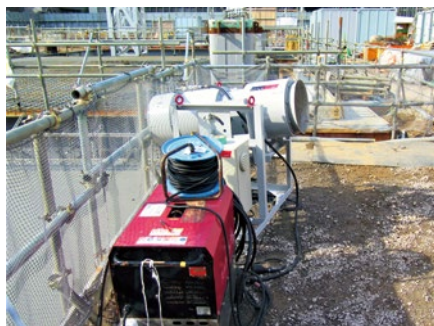
① 熱中症を予防するため、作業場の四方からミストファンで風を送る
