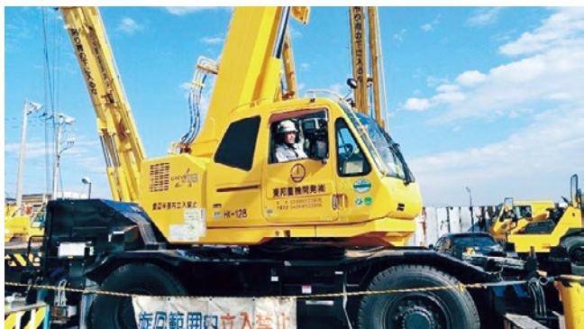
① モータープールでの移動式クレーンの操作練習
