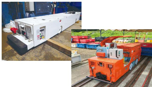
⑥現場に導入したバッテリー機関車(鉄建建設リリースより)
