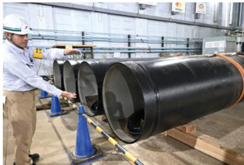
② 整然と並ぶダクティル鑄鉄製の内挿管 (φ1,000mm)
