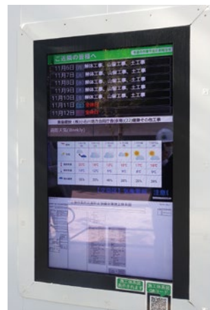
近隣に作業日程などを伝える仮囲いのデジタルサイネージ
